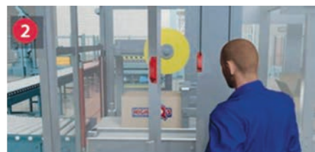
2. A gépkezelő kinyitja a reteszelt védőajtót, hogy rögzítse a szalagot. Az eszközállapot rögzített a rendszerben.
